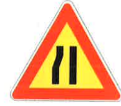
N. FIGURA 385 STRETTOIA ASIMMETRICA A SINISTRA
