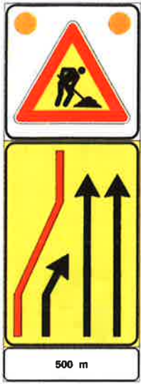
N. FIGURA 399/a PRESEGNALE DI CANTIERE MOBILE
