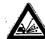
N. FIGURA 31 ART. 49 MATERIA INSTABILE SULLA STRADA
