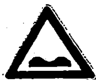
N. FIGURA 1 ART. 26 STRADA DEFORMATA
